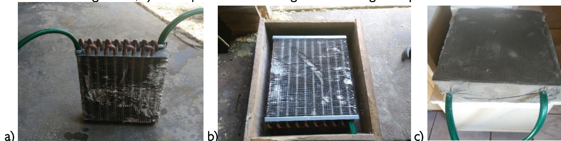
Figura 1 - a) Sistema de serpentinas para a circulação de água quente; b) Serpentinas num molde de madeira para preenchimento com argamassa; c) Molde preenchido com argamassa e mangueiras para conexão com as fontes de água
