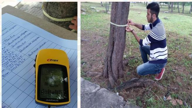
**Figura 3.** Georreferenciamento das árvores com GPS e verificação do diâmetro do caule com fita métrica.
