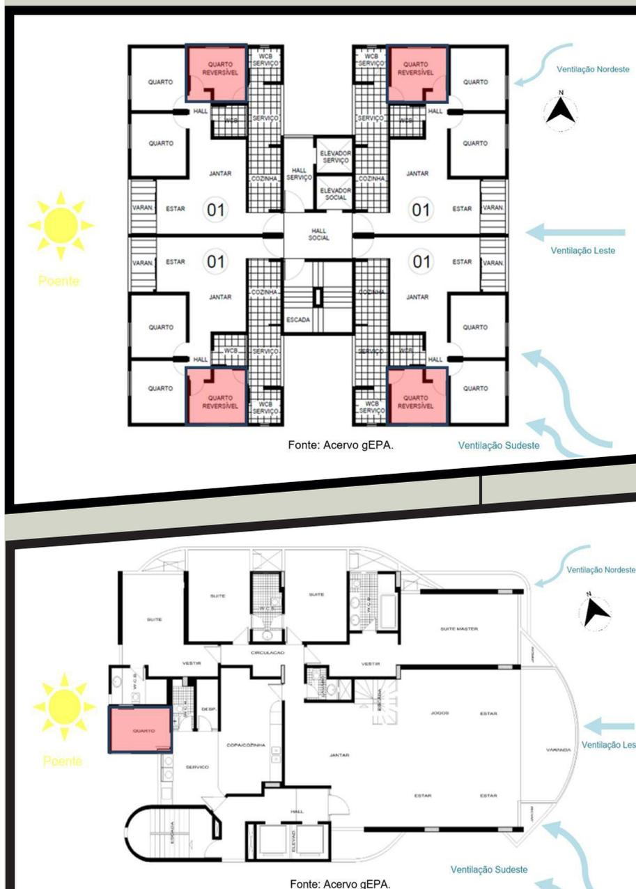
na, desde que tenha janela voltada para a área de serviço. Tal condição dificulta a ventilação no ambiente, porém, compensa bloqueando a insolação direta no dormitório (Figura 5).
